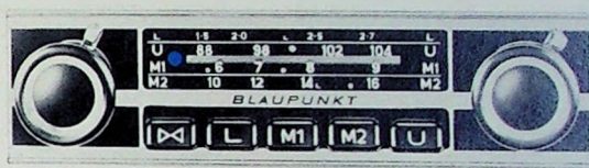
Blaupunkt Coburg Electronic. LW, MW 1, MW 2, UKW. Sucht und findet Sender elektronisch blitzschnell.
