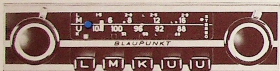
Blaupunkt Frankfurt Stereo, STEREO! LW, MW, KW, UKW-Stereo. 5 Stationsdrucktasten.
